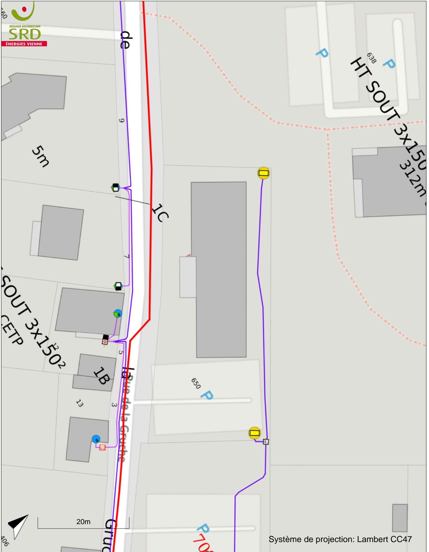
**Vue ensemble - Localisation des réseaux d'électricité souterrains BT et HTA**
